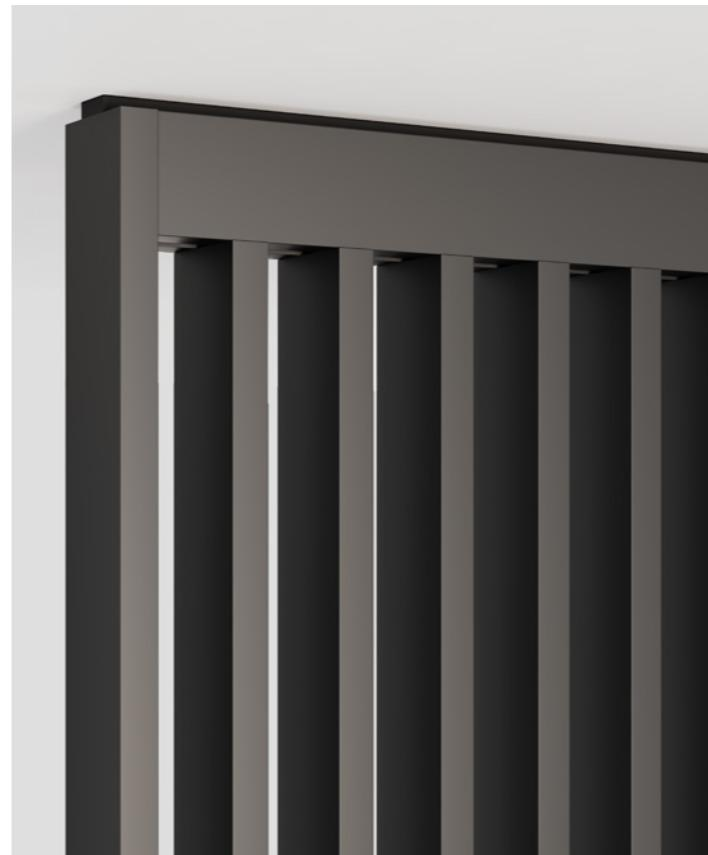
Nel fissaggio tra muri il pannello viene agganciato al soffitto mediante un sistema composto da 3 elementi principali: il piatto con perni di aggancio fissato a soffitto, il traverso superiore portante ed il carter di chiusura del traverso superiore.
