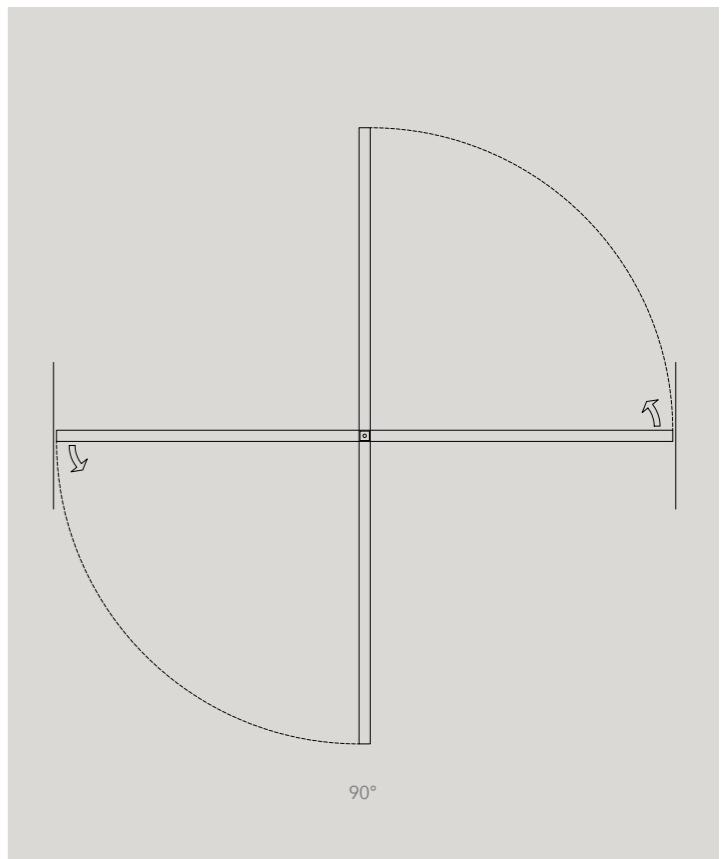
La cerniera dell'apertura a bilico è integrata nel profilo del telaio enfatizzandone la pulizia delle forme e permettendo l'eliminazione di qualsiasi predisposizione preliminare.
