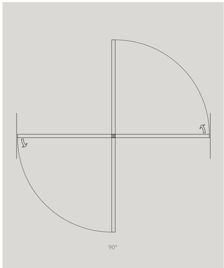
La cerniera dell'apertura a bilico è integrata nel profilo del telaio enfatizzandone la pulizia delle forme e permettendo l'eliminazione di qualsiasi predisposizione preliminare.
